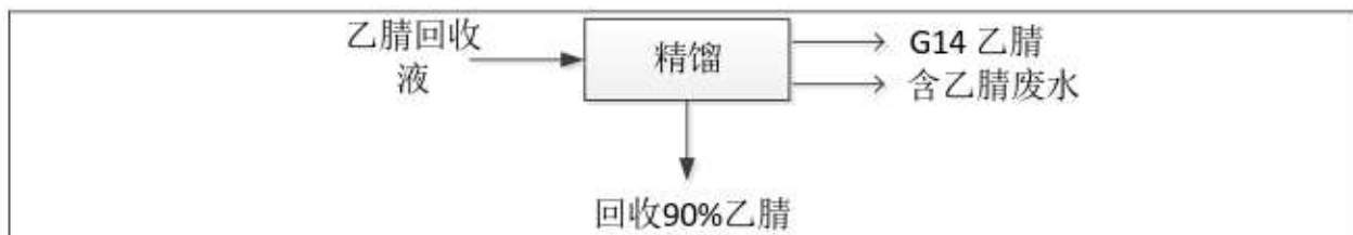
图 1-4 乙腈回收生产工艺及产污流程图
